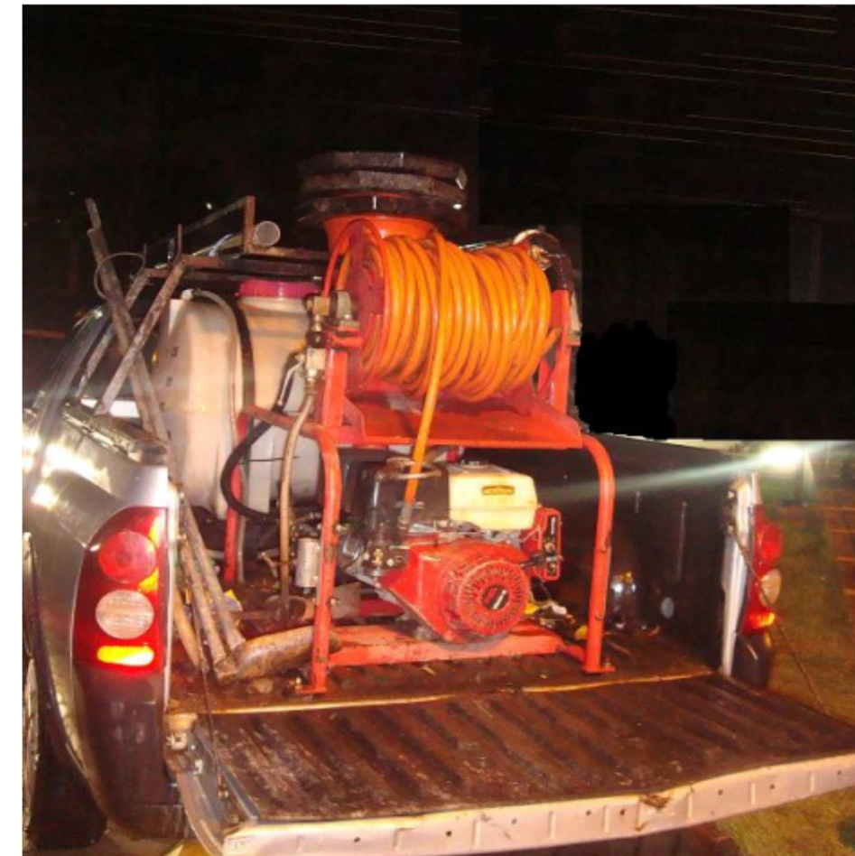
Figura 32. Equipamento de hidrojateamento instalado em veículo pick-up
