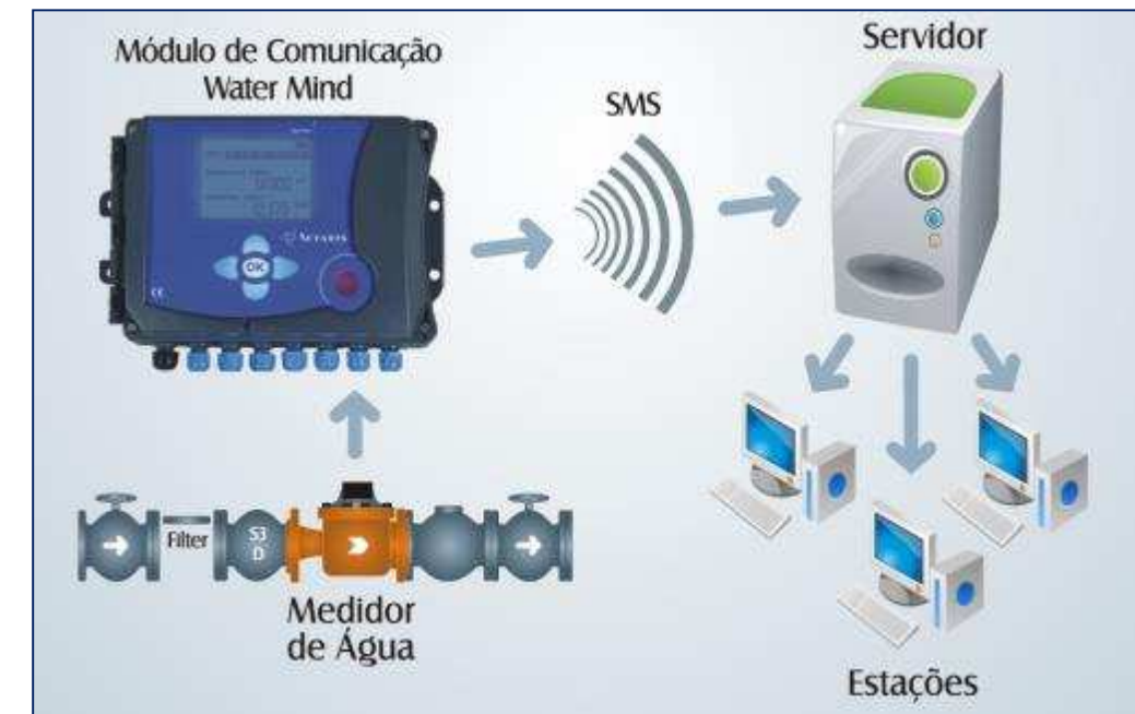
Figura 45. Figura esquemática, que demonstra o funcionamento do sistema de monitoramento remoto de consumo/cliente. Na figura observa-se o trâmite das informações
